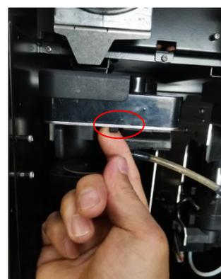
1. Gire o bico de descarga de café para fora e puxe-o verticalmente para baixo para remover o bico de descarga de café;
