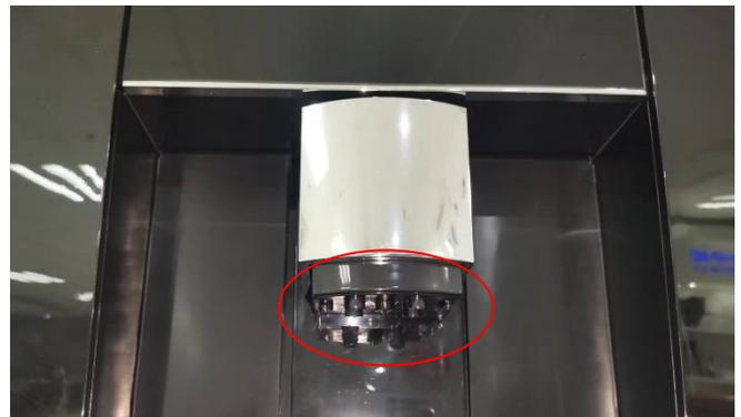
Use uma escova para limpar a parte inferior do braço do bico. Clique em Limpar->Máquina->Enxágue com uma tecla. Quando a água estiver saindo, use a escova para limpar o bico.
