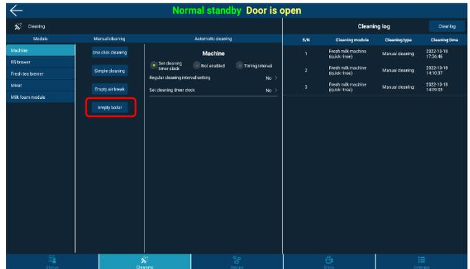
Puxe a bandeja de água, ligue o interruptor de drenagem, instale a bandeja de água, digite a senha em segundo plano, desconecte a fonte de água conectada à máquina ou desconecte o plug de alimentação da bomba, clique no canto inferior direito [limpeza], clique em [esvaziar caldeira]. Após esperar três minutos, feche a porta e desconecte a máquina da tomada.
