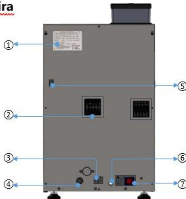
① placa de identificação ② saída de ventilação ③ entrada de água ④ saída de água da caldeira ⑤ porta MDB ⑥ Descarga de águas residuais ⑦ interruptor de alimentação
