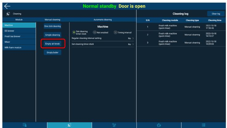
Prepare o balde na saída de bebidas para uso e clique em **【Esvaziar Air Break】**. Após esperar três minutos, feche a porta da máquina e desconecte-a da tomada.
