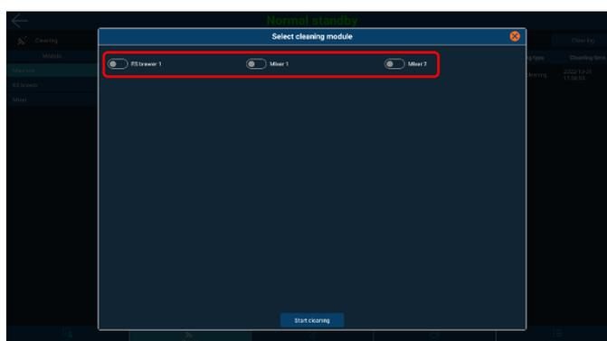
Interface da tela de manutenção. Entre com login – Guia de Limpeza – Módulo - Máquina - Limpeza manual - Limpeza com um clique/ Limpeza rápida. A limpeza com um clique limpa todo o sistema de água, incluindo os tubos, de uma só vez. A limpeza rápida é a limpeza do módulo selecionado no menu pop-up.
