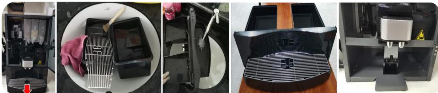
Puxe a bandeja coletora para fora da máquina e descarte o pó de café e o pó de chá; Use água limpa e um produto de limpeza doméstico para limpar completamente o balde de resíduos e a bandeja coletora; Após a limpeza, seque o balde de resíduos e o interior da máquina com uma toalha limpa; Por fim, coloque a bandeja coletora de volta na máquina.
