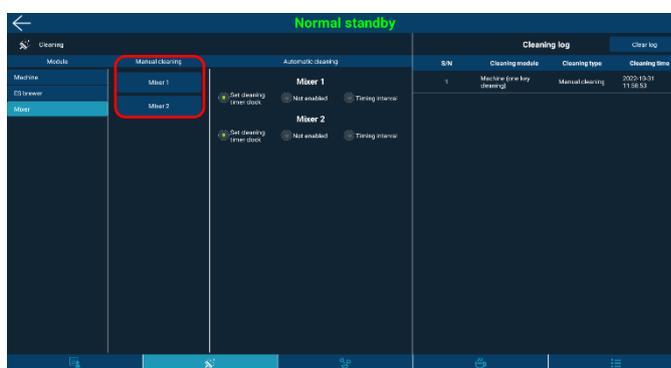
Limpeza da infusor: módulo-infusor 1 limpeza manual-limpeza rápida
