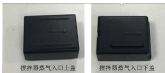
Puxe o tubo de silicone do misturador para fora; Gire o anel de fixação vermelho no sentido horário e, após destravar, puxe o misturador para fora; e remova as tampas superior e inferior; Limpe a tampa do misturador, o corpo do misturador, o anel de pressão e as tampas superior e inferior, seque-os e coloque-os de volta.
